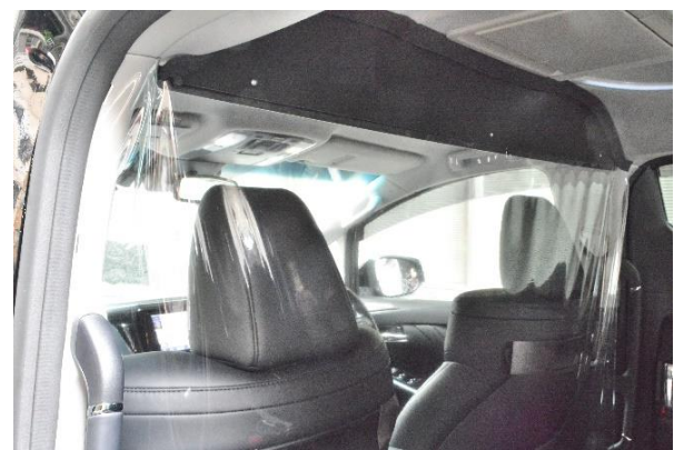
飛沫感染防止のための透明ビニールカーテン (ハイヤー)
