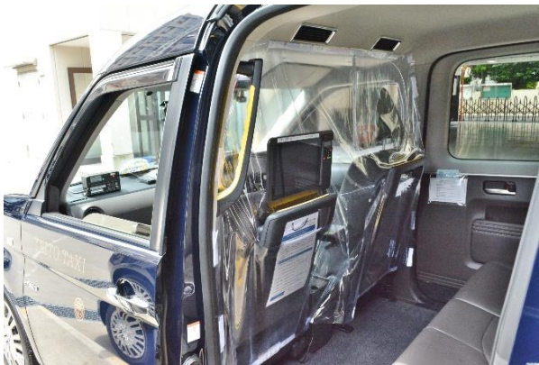
飛沫感染防止のための透明ビニールカーテン (タクシー)
